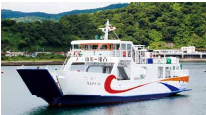
フェリーなんきゅう概要：総トン数136トン／全長約34メートル／幅約8.6メートル／積載能力・旅客95人・車両大型車2台・乗用車6台（普通車の場合18台程度が積載可能）／速力10.5ノット
