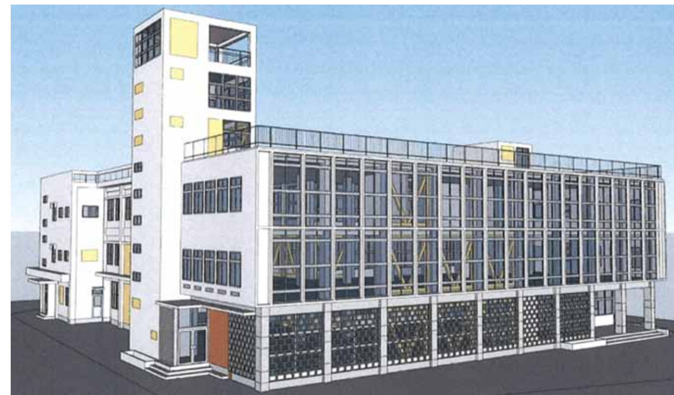
▲RC壁による開口閉塞と鉄骨ブレースを挿入する内付主体の工法を用いたイメージ図。 （イメージ図は現時点のものであり、今後の実施設計等により、一部変更となる場合もあります。）
