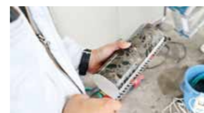
▲切り抜いたコアは、強度試験や薬品を用いて検査します。
