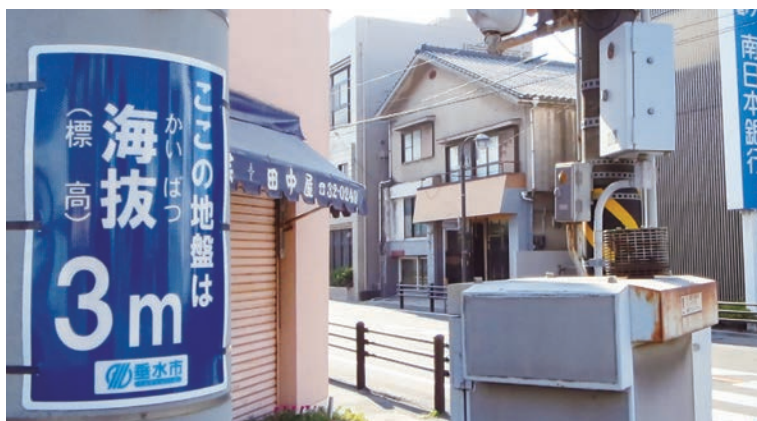
標高表示板①規格：スーパーボード製、高さ 45cm × 幅 30cm ②基準高：東京湾平均海面高③デザインは国交省が設置予定のものとはほぼ統一した。写真は、国道 220 号の市役所前交差点に設置された標高表示板。
